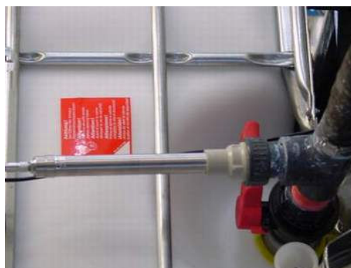
Abb. 3: Einsatz eines Einsteck-Messgerätes Aello 1500 im Ausfluss eines Großgebides
